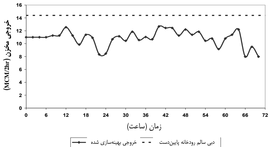
شکل ۳- مقایسه دبی رودخانه پایین دست و خروجی بهینه‌سازی شده توسط الگوریتم ژنتیک برای سیلاب اردیبهشت ۱۳۷۲
