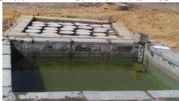
Fig. 2- The pond covered with Unoring compared to pond without cover (control) شکل ۲- نمایی از حوضچه پوشانیده شده با یونورینگ در مقایسه با حوضچه فاقد پوشش (شاهد)
